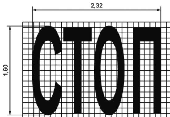
Рисунок Б.8 - Расположение и размеры букв разметки 1.21
