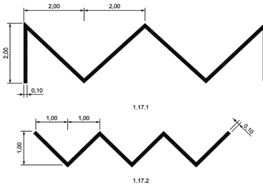
Рисунок Б.4 - Размеры разметки 1.17.1 и 1.17.2
