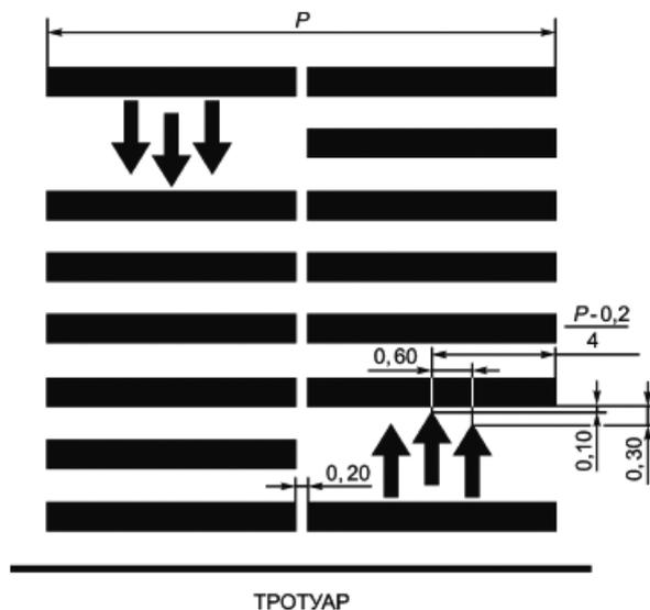
Рисунок Б.2 - Расположение стрел на разметке 1.14.2
