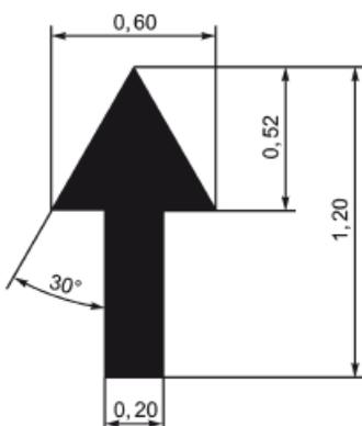
Рисунок Б.3 - Размеры стрел на разметке 1.14.2
