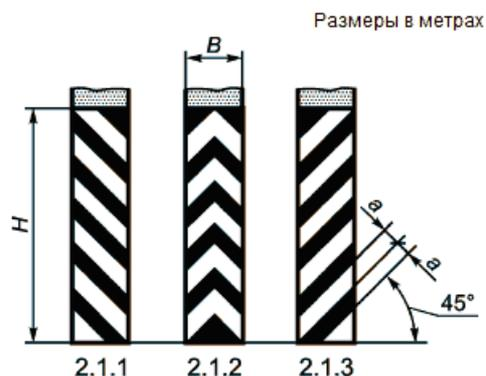
Рисунок Г.1 - Размеры разметки 2.1.1, 2.1.2, 2.1.3
