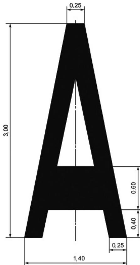
Рисунок Б.11 - Размеры разметки 1.23.1
