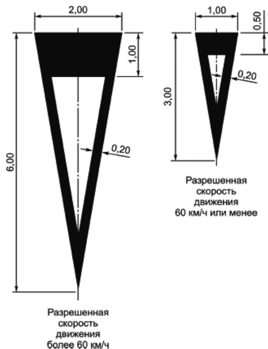
Рисунок Б.7 - Размеры разметки 1.20
