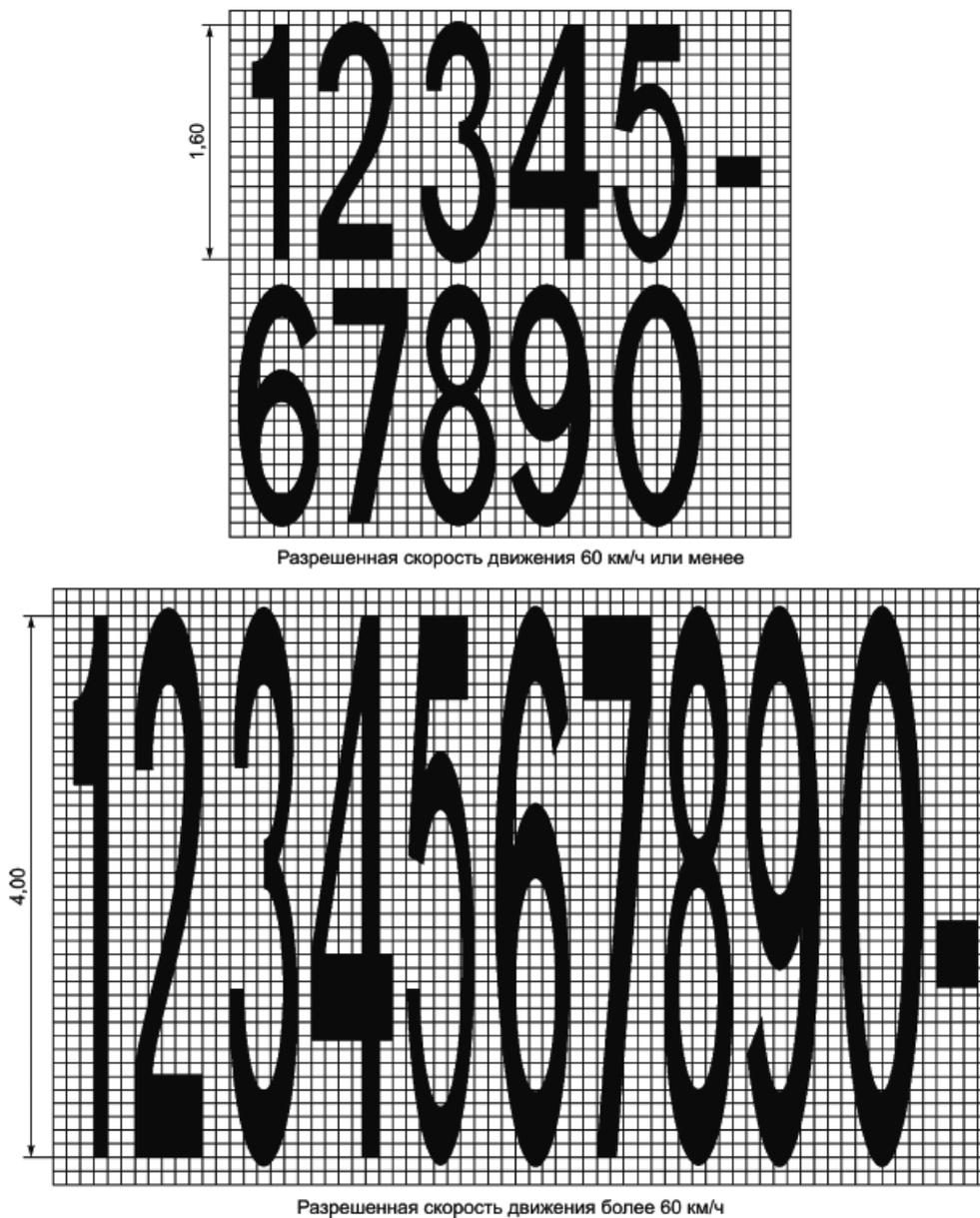
Рисунок Б.9 - Расположение и размеры цифр разметки типа 1.22
