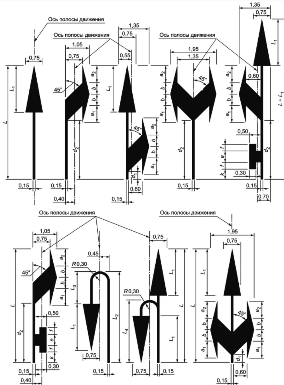
Рисунок Б.5 - Размеры стрел разметки типа 1.18
